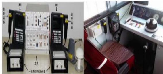
无线列调通信设备应用场景
