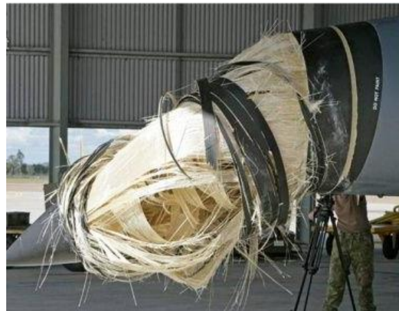
图表 50： 战斗机石英纤维雷达罩
