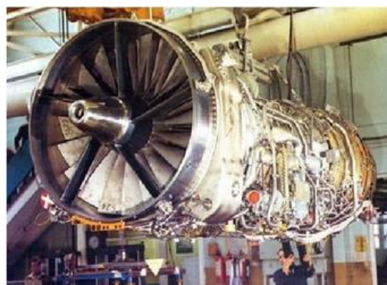
图 9：涡轮喷气式发动机：奥林帕斯 593
