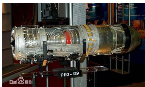
图 11：涡轮风扇发动机：F110
