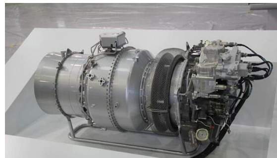
图 15: 涡轴发动机: 涡轴 16
