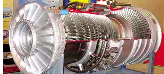
图 22：中国 R0110 重型燃气轮机
