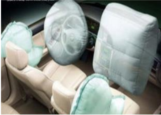
图 44: 传统汽车安全气囊布局
