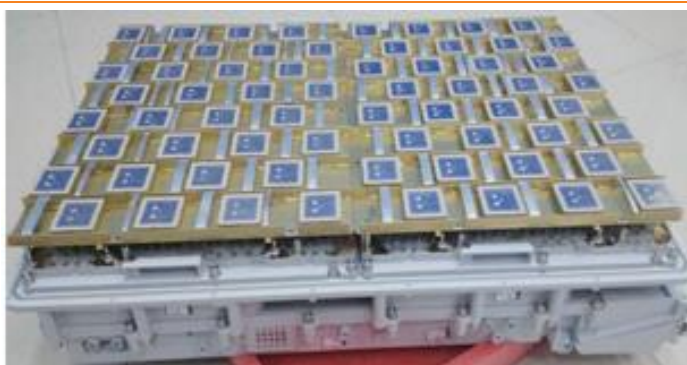
图 43：4.5G Massive MIMO 天线阵面原理样机
