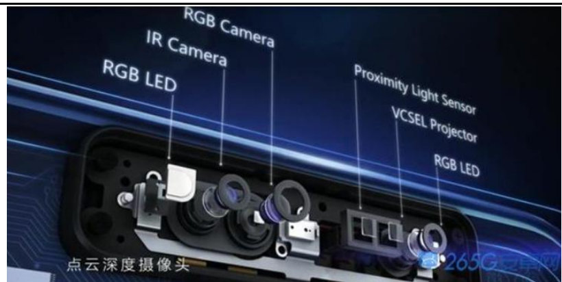
图表 24: 荣耀 V10 外设点云深度摄像头配件结构
