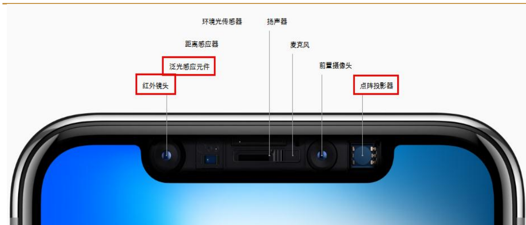
图 33：iPhone X 原深感摄像头构成
