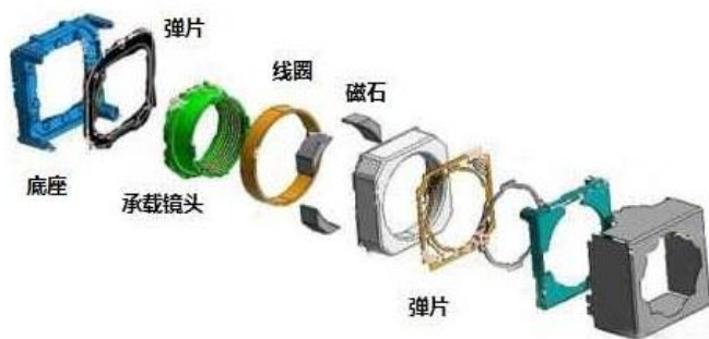
图 101：音圈马达构成
