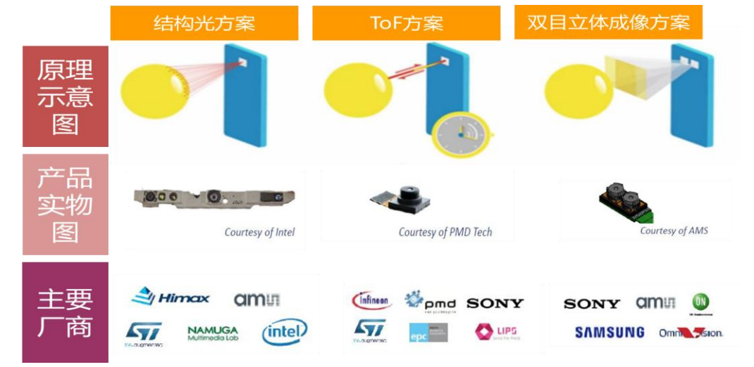
图 32：3D Sensing 3 种主流方案原理图、示意图以及主要厂商
