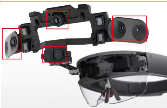
图 39: HoloLens 构造里的 3D 感知摄像头和传感器
