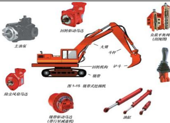
图5: 挖机内部使用的主要液压元件
