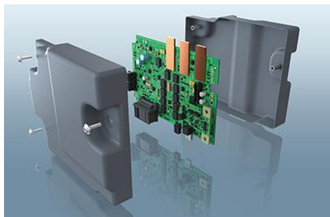
图 22：新能源汽车快充系统 BMS
