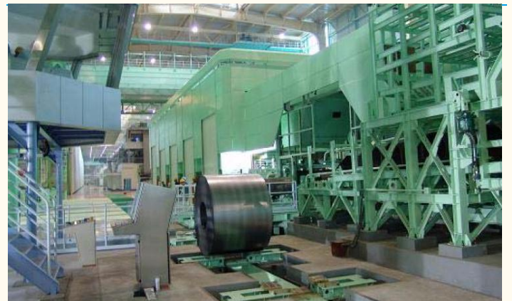
图表 24：公司生产的我国第一套 2130 毫米五机架冷轧机
