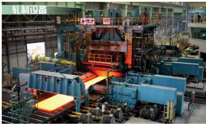
图表 23：公司生产的 5500 毫米宽厚板轧机
