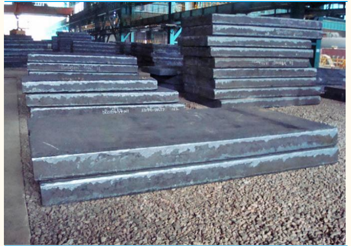
图表 22：造船及海上采油平台用特厚钢板
