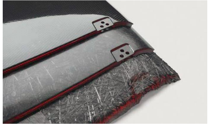
图 38: 利用 PVP 技术制造的 CFRP 材料
