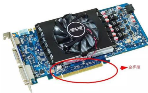
图 37：金手指镀金层质量影响电路板性能
