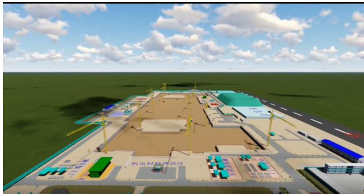
图 16: BIM 软件用于北京城区副中心项目实现三维场地布置
