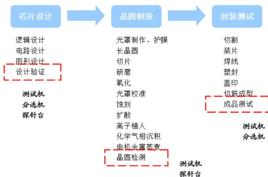
图 16：测试设备应用于芯片生产各个环节
