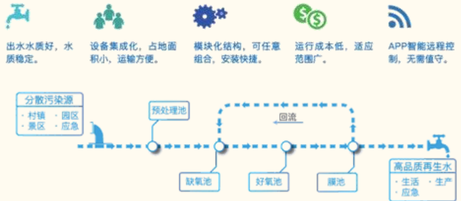
图表 19: CWT 特点及工艺流程
