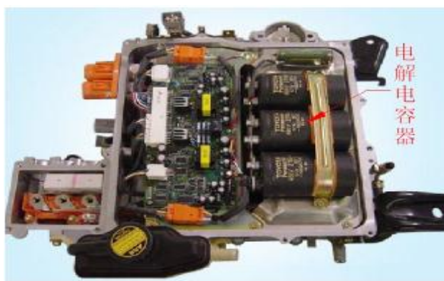
图27: 第一代丰田普锐斯电机控制器
