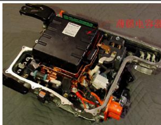
图28: 第二代丰田普锐斯电机控制器
