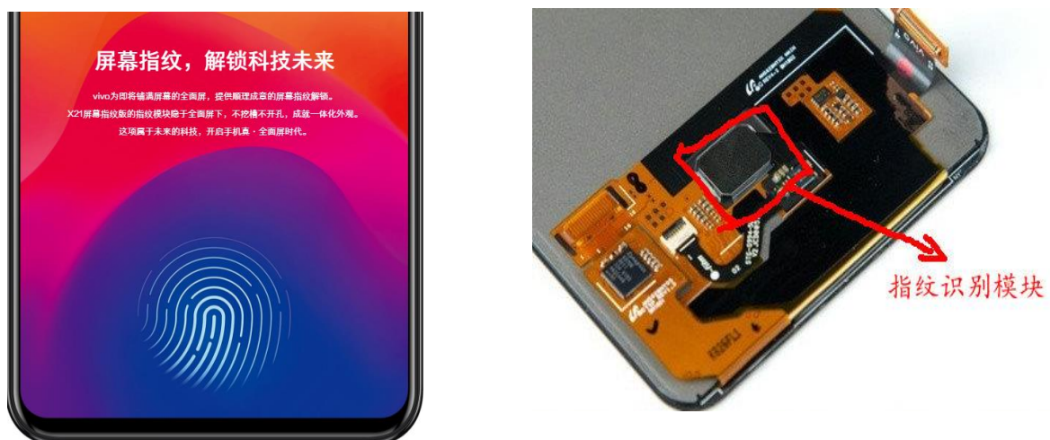
图表 19: VIVO X21 屏下指纹版指纹模组拆解示意图
