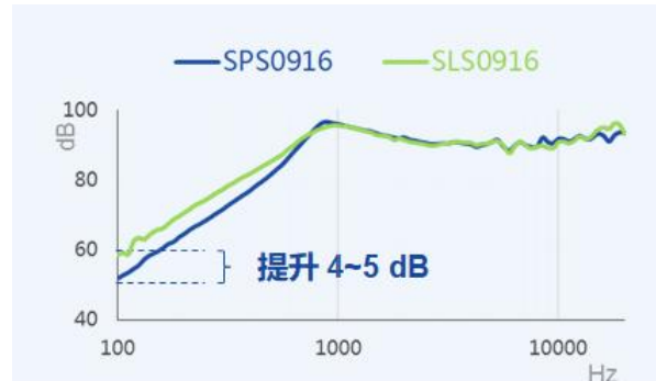
图 42：尺寸不变情况下 SLS 结构可以提升中低频
