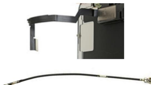
图 30: iPhone 8/8P/X 用 LCP 传输线代替射频同轴电缆
