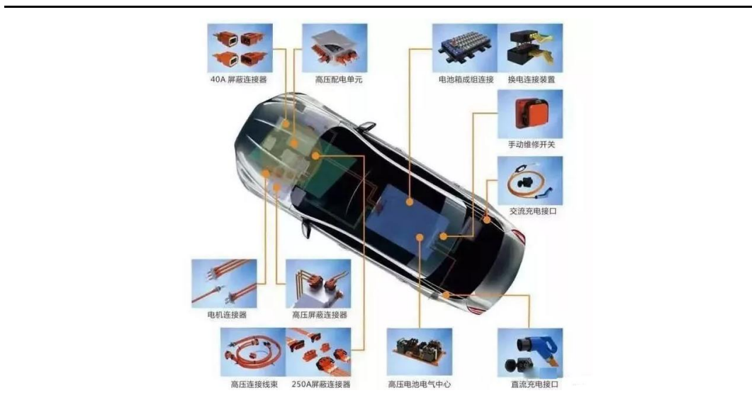
图 57：新能源汽车高压大电流系统部件
