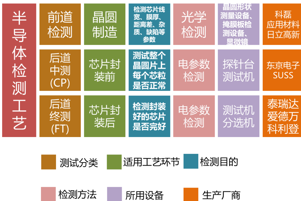
图 14：半导体不同测试工艺的使用场合及所使用设备情况
