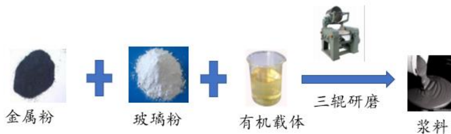
图表 100: 电子浆料制作流程
