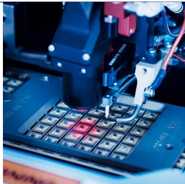
图表 93：绑定机上的劈刀封装示意图
