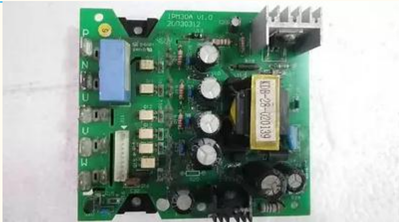
图表 26：格力变频空调电源板
