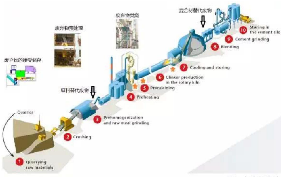
图49：水泥窑协同处置危险废物的工艺流程图
