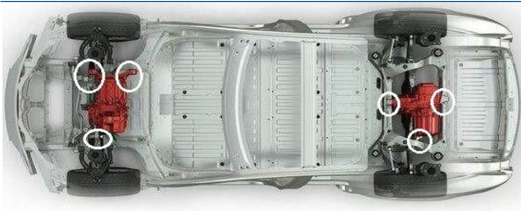
图 40：双电机电动车——特斯拉 Model S 的悬置位置
