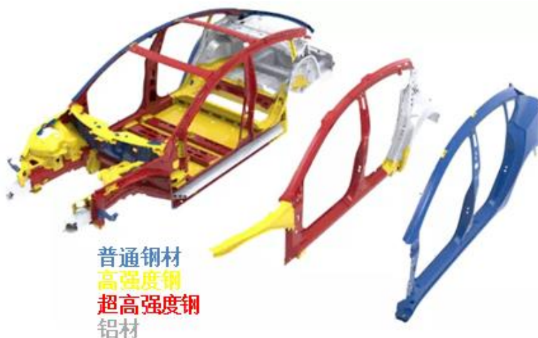
图 28: 车身结构件中不同种类钢材、铝材的应用
