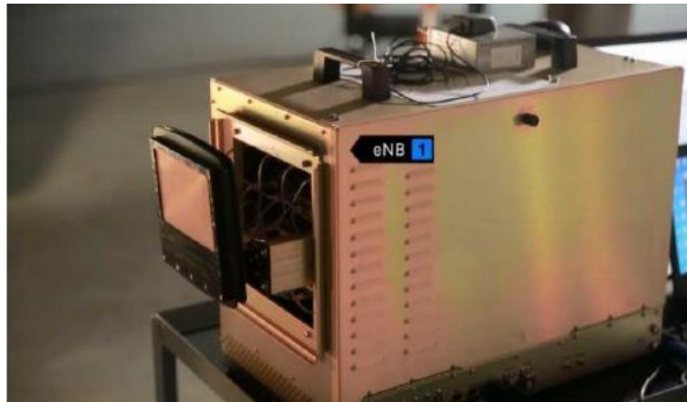
图 36: 高通 5G 毫米波演示系统中的基站天线设备
