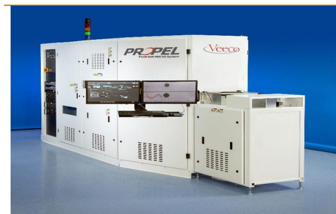
图 13：Veeco 的功率氮化镓 MOCVD 系统
