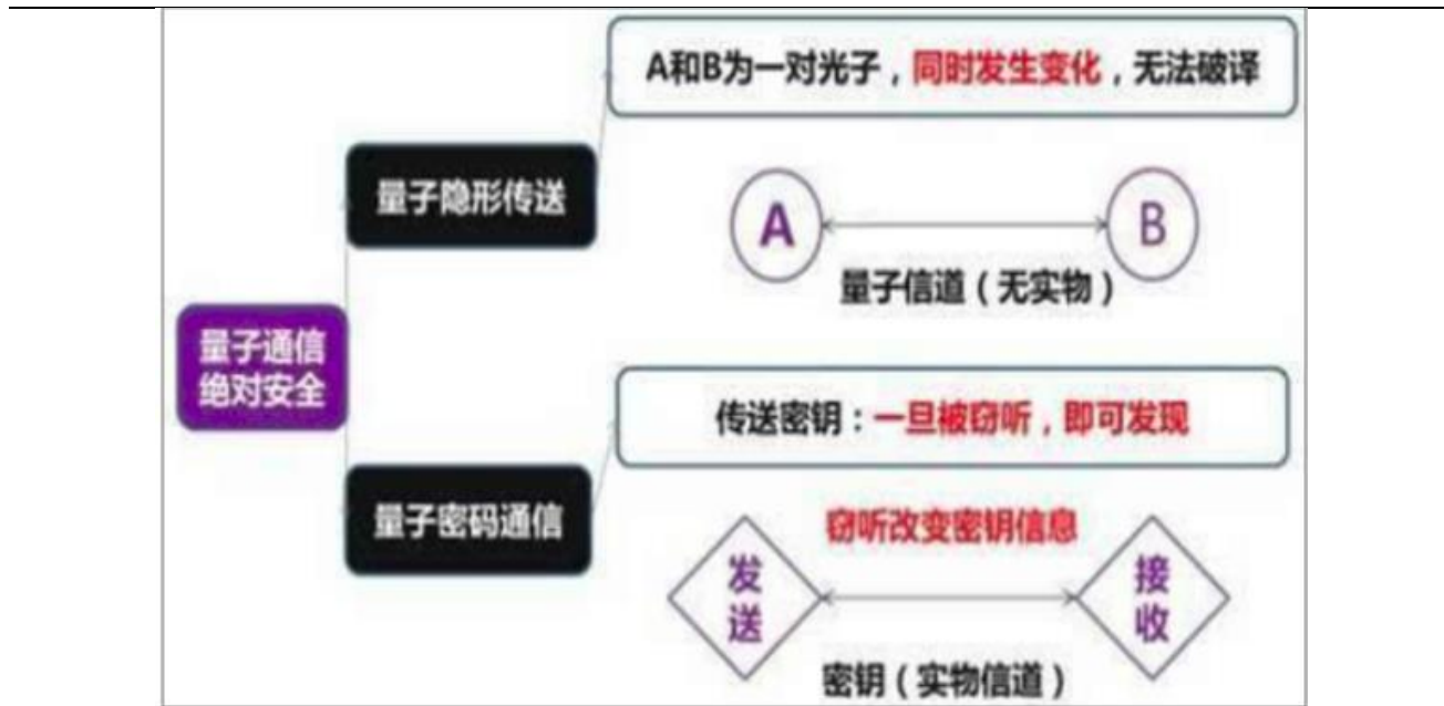
图 19：量子通信绝对安全实现原理
