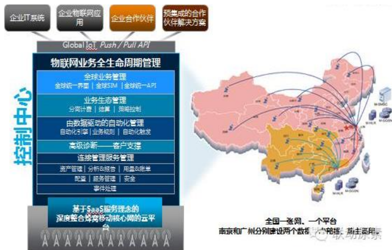
图：中国联通物联网平台蜂窝连接管理架构
