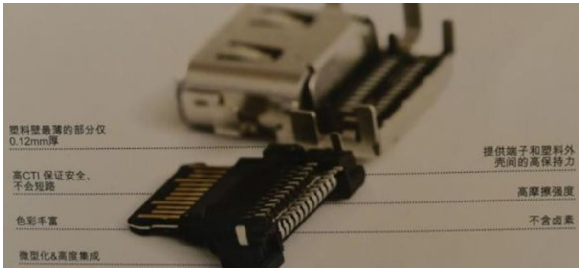
图 9: USB Type-C 内部结构及对材料的要求提升，单机价值提升
