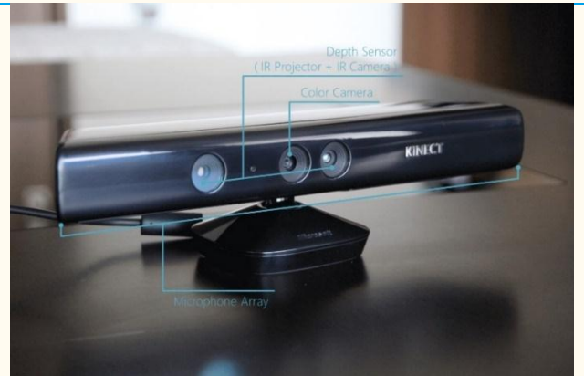
图表 24：基于结构光的 Microsoft Kinect 第一代
