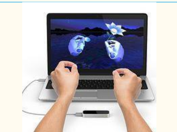
图表 28: 基于双目立体视觉的 Leap Motion
