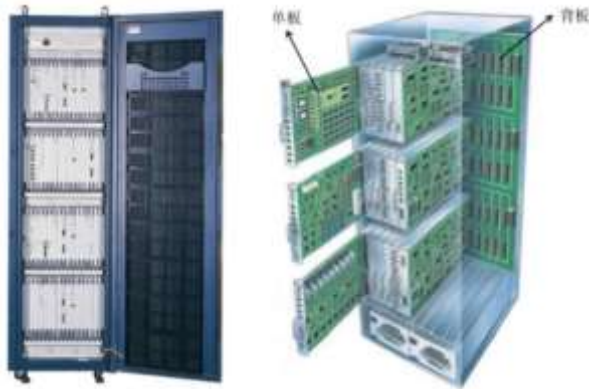
图 37: 通信基站中的背板和单板
