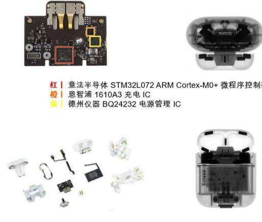
红 | 意法半导体 STM32L072 ARM Cortex-M0+ 微程序控制器
