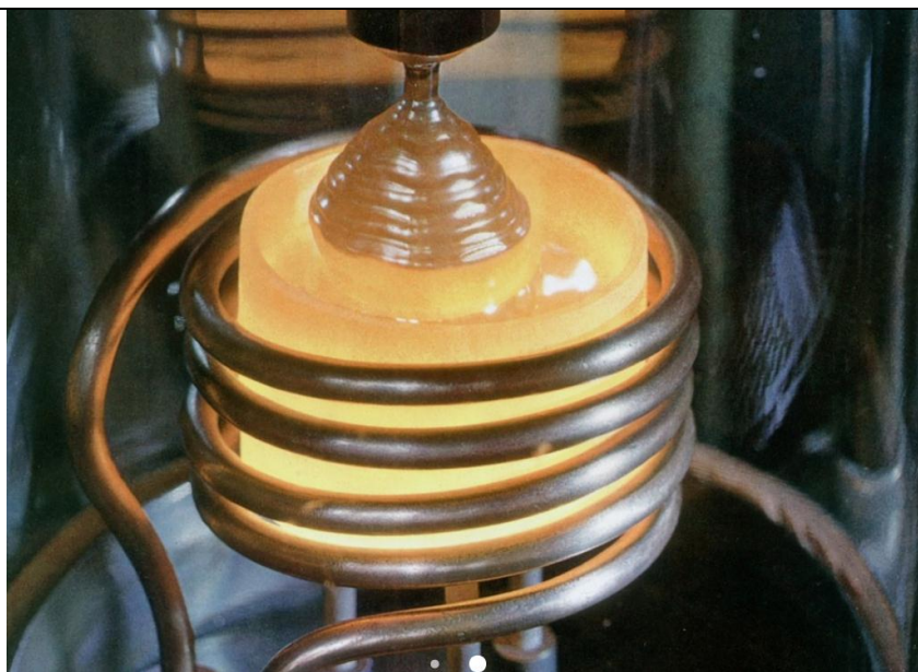
图 7：1961 年博世锗晶体制造过程
