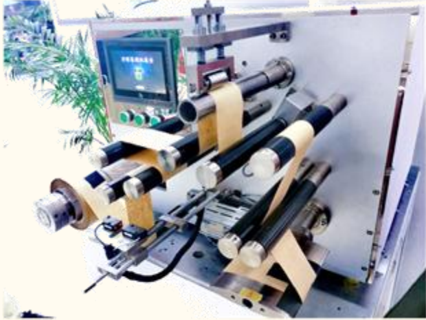
图表 88: 汇川方形卷绕机基于 EtherCAT 总线方案可完成整套系统拓扑搭建和工艺实现
