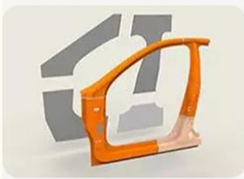
图表 42：高强度钢-激光拼焊板
