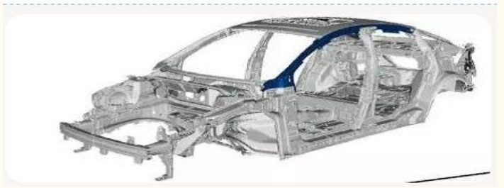
图表 41：高强度钢管/框架结构焊接
