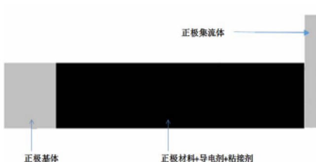
图 19：锂离子电池正极极片构成
