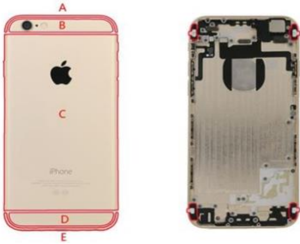
图 14: Iphone6 采用注塑白条设计解决信号屏蔽问题
