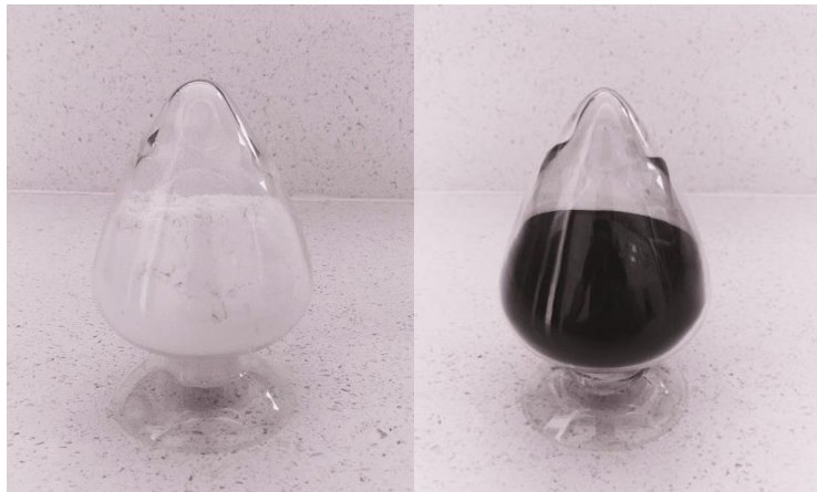
图表32. 公司电池级无水磷酸铁（左）与高倍率纳米级磷酸铁锂（右）
