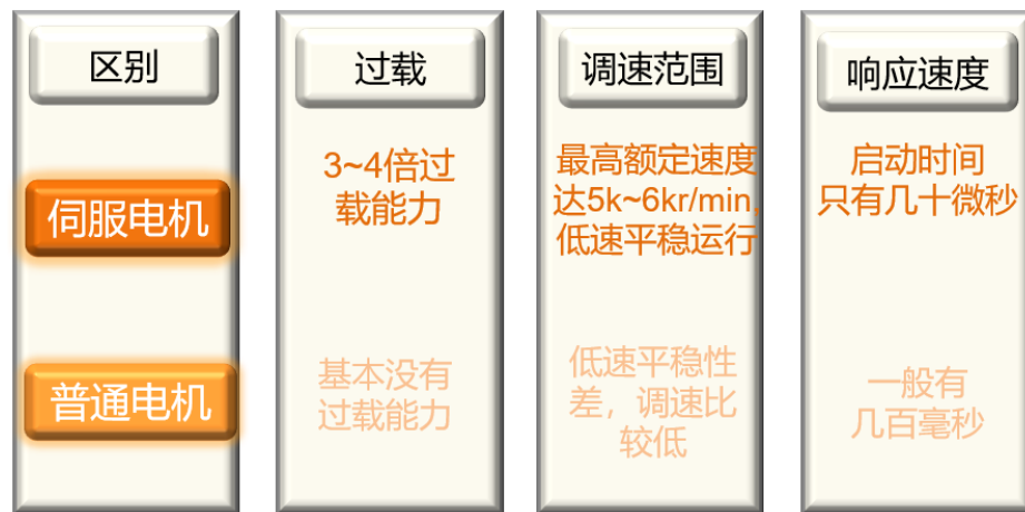
图表9 伺服电机多项性能指标优于普通电机
