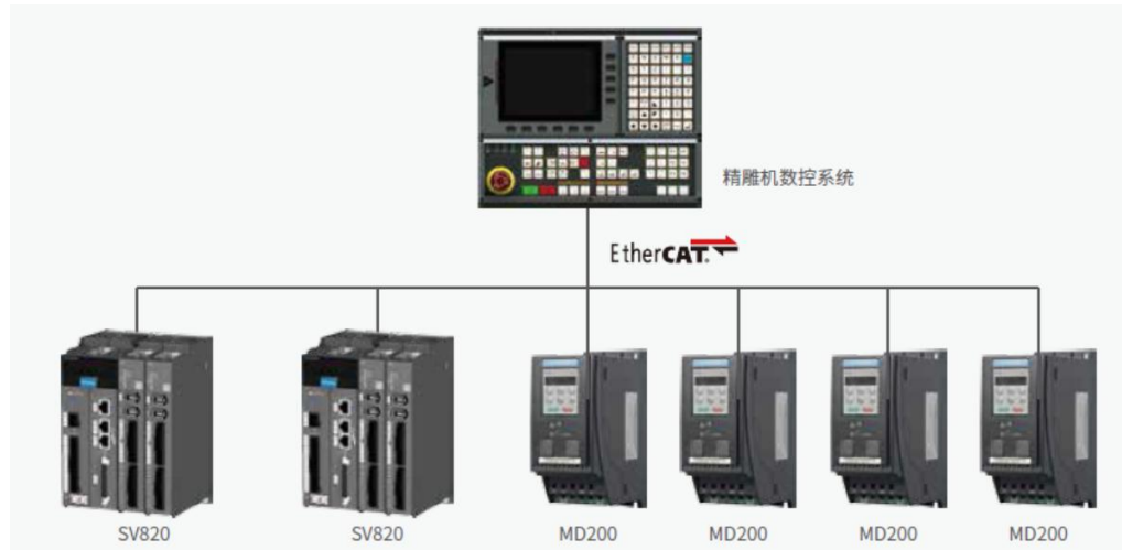
图表34 汇川精雕机数控系统为客户同时提供伺服和变频产品
