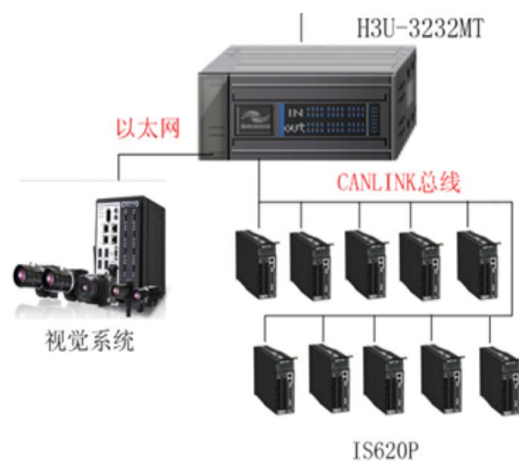
图表23 伺服系统在贴片机上的应用
