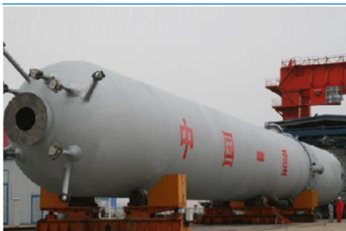
图 16：世界单重最大的煤液化反应器
