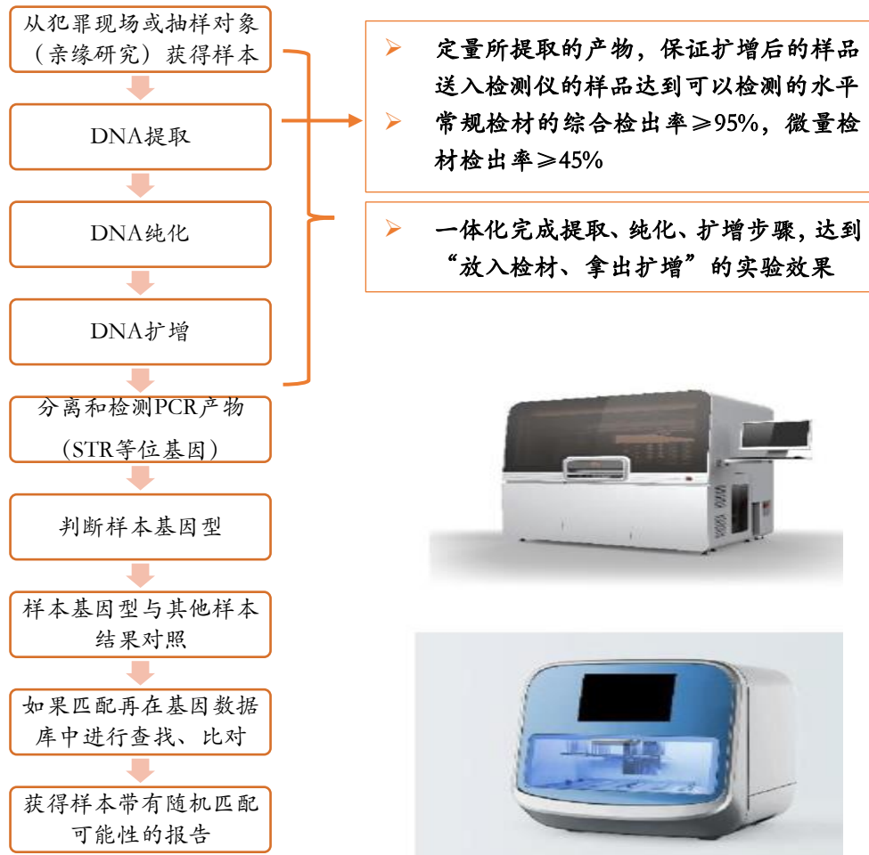
图表27 单细胞超微量 DNA 提取检测工作站在提取过程进行“初筛”具有显著的优势
