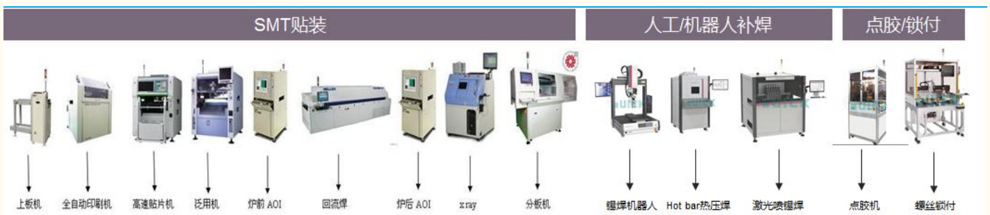
图表 19：电子装联主要工艺流程及设备
