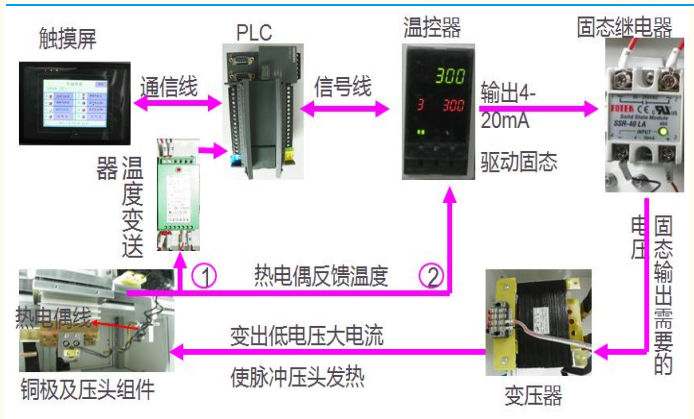
图表 13：hotbar 热压焊工艺原理
