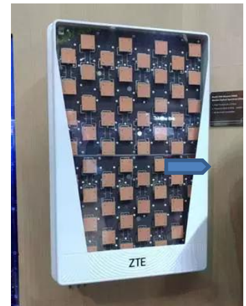
图表 10: 传统天线内部的馈线网络结构—> AAU 的内部 PCB 结构
