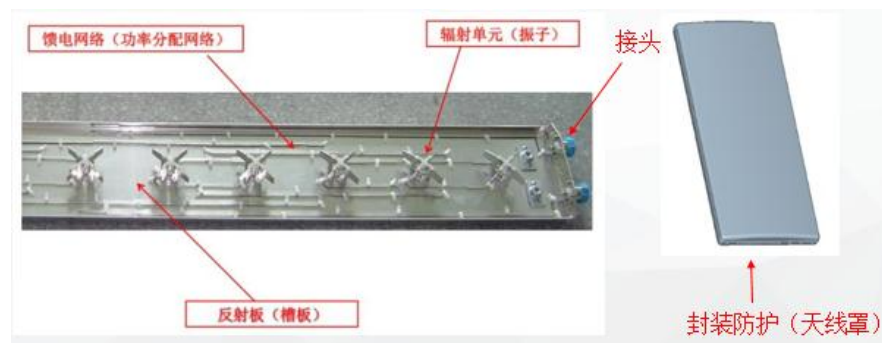
图 11: 天线内部构成
