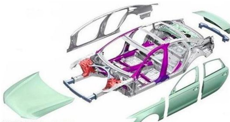
图 91：铝在汽车中的应用——“四门两盖”
