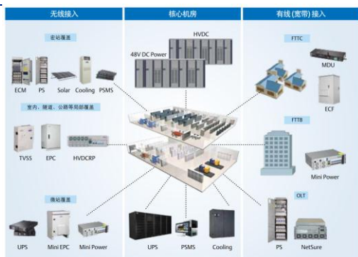
图 3：电信场景下的电源应用
