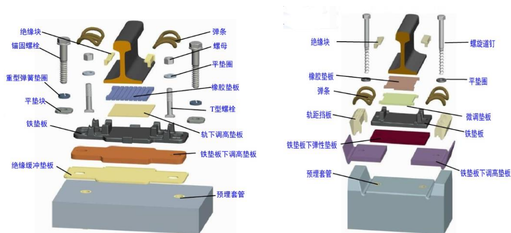
图 5: WJ-7 型扣件 (左) 和 WJ-8 型扣件 (右)
