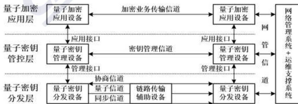
图 7 量子保密通信系统原理图
