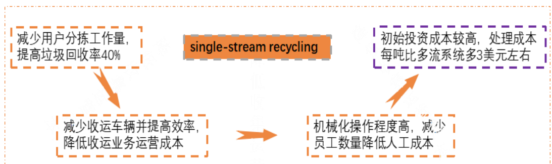
图表25 single-stream recycling 的优缺点
