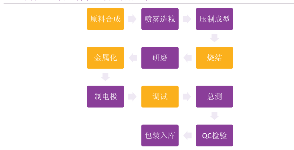
图表8：陶瓷介质滤波器制作流程
