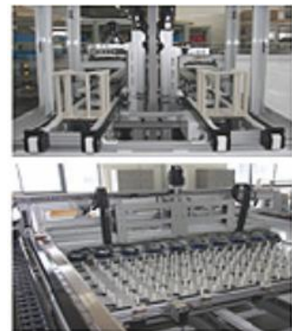
图表 10: PECVD 上下料机内部示意图
